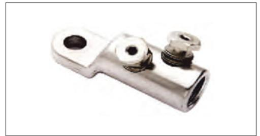
**Verwendung** Dienen als Abschluss von Kabeln mit Adern aus Aluminium und Kupfer, Rund- und Sektorader, für Spannungen bis zu 36kV. Für mehr Sicherheit, Festigkeit und Qualität der Verbindung durch Reißschrauben nach dem Erreichen des entsprechenden Anziehmoments.
