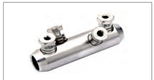
**Verwendung** Dienen zum Verbinden von Kabeln mit Adern aus Aluminium und Kupfer, Rund- und Sektorader, für Spannungen bis zu 36kV. Für mehr Sicherheit, Festigkeit und Qualität der Verbindung durch Reißschrauben nach dem Erreichen des entsprechenden Anziehmoments.
