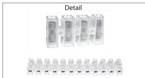
**Verwendung** Klemmleisten, 12-reihig dienen zum Anschließen von Adern in Installationsdosen, in der Beleuchtungstechnik, in Schaltschränken sowie für andere Elektroarbeiten. Sie gewährleisten einfache Trennung von einzelnen Stromstrecken sowie können mit Hilfe eines Messers leicht gekürzt werden. Die Leiste verfügt über Öffnungen für Befestigung am Untergrund.
